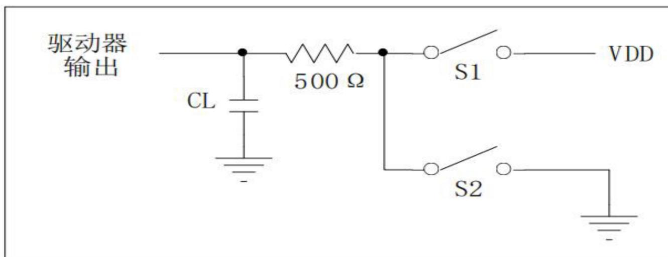
图 3 驱动器使能/无效时序测试
