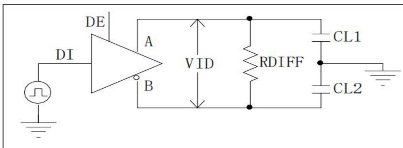
图 2 驱动器时序测试电路
