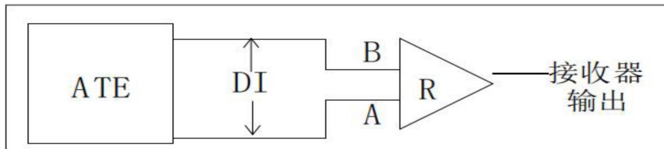
图 4 接收器传播延时测试电路
