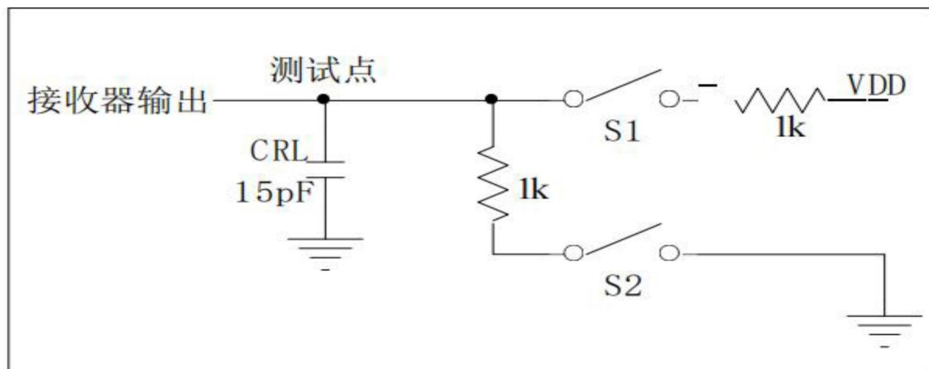
图 5 接收器使能/无效时序测试
